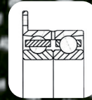
Geflanshtes doppelreihiges Schrägkugellager mit Phenolkäfig. Nimmt Axiallast in beiden Richtungen sowie Radiallast auf. Spiel/Vorspannung nach Bedarf.
