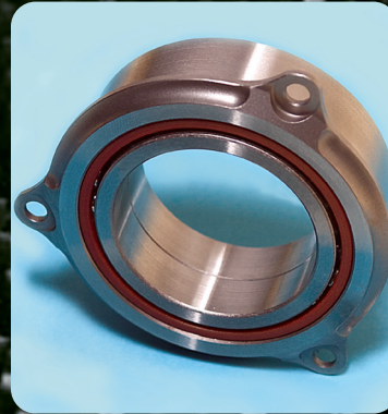
Geflanshtes doppelreihiges Schrägkugellager mit Phenolkäfig. Nimmt Axiallast in beiden Richtungen sowie Radiallast auf. Spiel/Vorspannung nach Bedarf.
