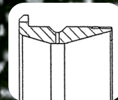
Geflanshtes doppelreihiges Schrägkugellager mit Phenolkäfig. Nimmt Axiallast in beiden Richtungen sowie Radiallast auf. Spiel/Vorspannung nach Bedarf.
