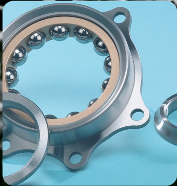
Geflanshtes Duplex-Kugellager für die Axiallastaufnahme in beiden Richtungen. Axialspiel/Vorspannung nach Kundenanforderungen.
